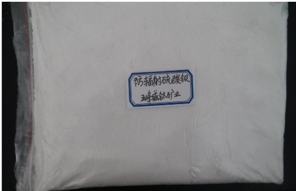
天然沉淀硫酸钡的用途有哪些？首要用于石油和天然气钻井泥浆的加剧剂，也是获取金属钡和制取各种钡化合物的重要矿藏质料。工业上重的钡化合物有碳酸钡、氯化钡、硫酸嵌、硝酸钡、氢氧化钡、氧化钡、过氧化钡、铬酸钡、锰酸钡、氯酸钡、锌钡白、多硫化钡等。沉淀硫酸钡用处非常广：用作橡胶、塑料、颜料、涂料、造纸、纺织品、油漆、油墨、焊条的质料及填料；用作钡基润滑脂、油料精制、甜菜制糖、人造丝的质料；用作杀虫剂、灭菌剂、灭鼠剂、绿色焰火、信号弹、曳光弹、医学X光照像的指示剂等；还用于玻璃、陶瓷、皮革、电子、建材、冶金等部分。
